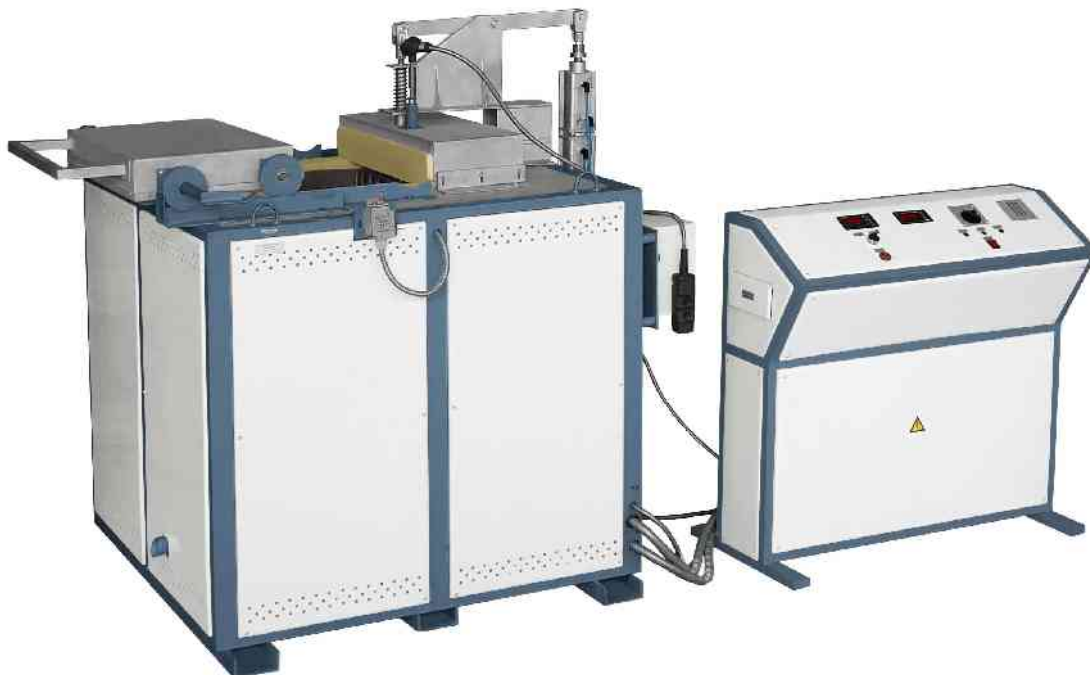
Рис. 1. Электропечь для плавки нового баббита, подогрева расплава до температуры заливки и полуавтоматического розлива его по формам
