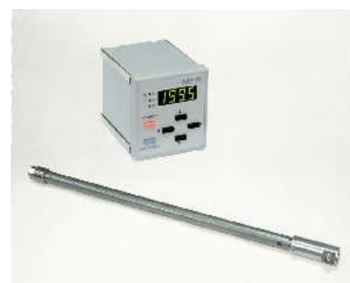
Рис.4 Индикатор азотного потенциала АЗП-10 и датчик измерения парциального давления кислорода с твердо-электродной ячейкой.
