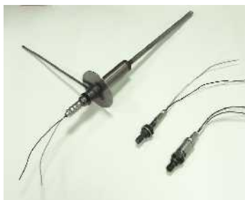
Рис.3. Импортные датчики для измерения содержания кислорода в выхлопных газах.
