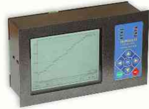
Рис.2 Электронный самописец ТЕРМОДАТ предоставляет графическую диаграмму техпроцесса и обеспечивает измерение температуры
