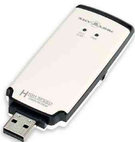
Радиомодем для связи печи с сетью интернет
