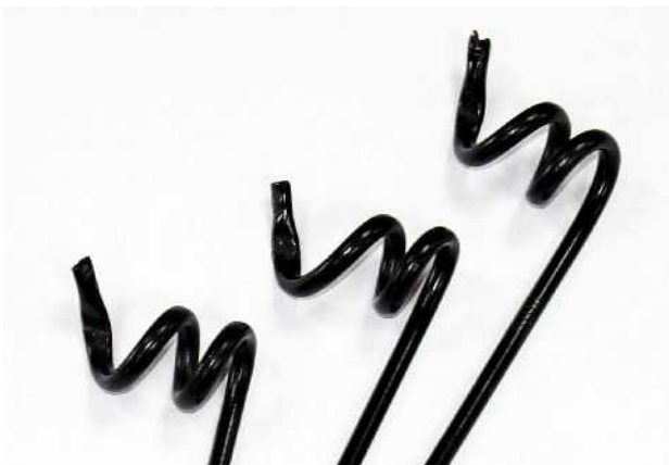
Рис. 2. Испытание качества нанесения порошкового покрытия на тонкостенные трубки.
